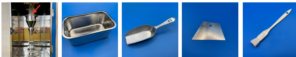
図 8. 付属品を使用し試料用ホッパー上部よりサンプル装入
