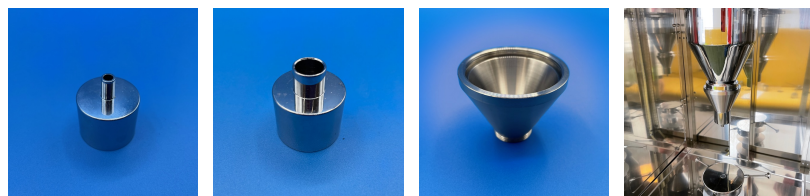
図 6. 選定した排出ノズル付きの試料供給用ロート部の取付
