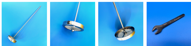
図4. 振動網をスパナで振動棒に取付
