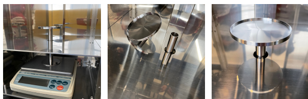
図 1 4. 電子天秤上に測定器下部の穴を通して分散度測定用測定皿を設置
