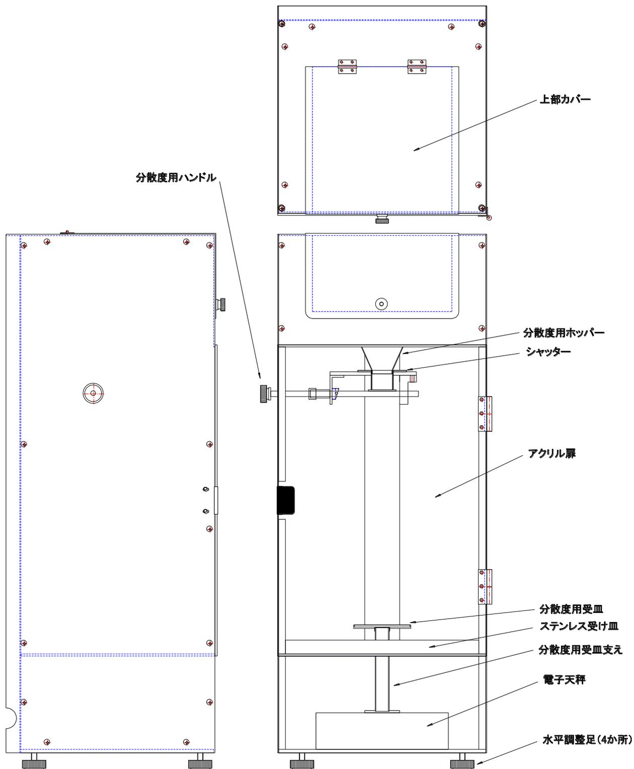
図2. 分散度測定器 (D 本体一式) 組立図
