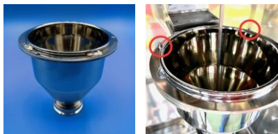
図3. 試料用ホッパーを測定器内のホルダー取付板に取付
