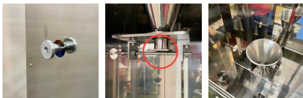
図 1 3. 分散度用ハンドルを半回転し分散度用ホッパーのシャッターを閉じる
