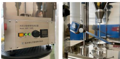
図9. 安息角測定用角度計を用いてサンプルの山の右斜面の角度を測定
