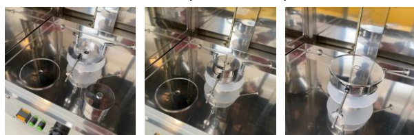
図7. 円台に試料（測定）台を設置し選定した測定円板を設置
