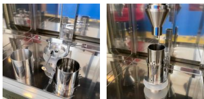
図1 2. 円台上のかさ密度測定用試料容器に測定枠を設置
