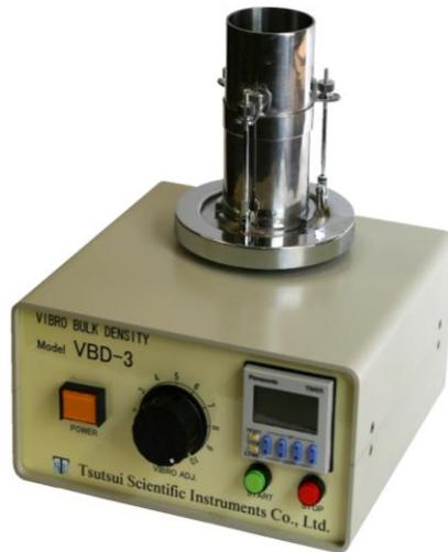
かさ密度には試料容器にゆるく充填した場合の疎充填かさ密度（JIS かさ比重測定器各種、吊下電磁振動式疎充填かさ密度測定器 MVD-86 型等）と、固く充填した場合の密充填かさ密度があります。本器は電磁振動により試料容器を振動させ、固く密充填にする装置です。
