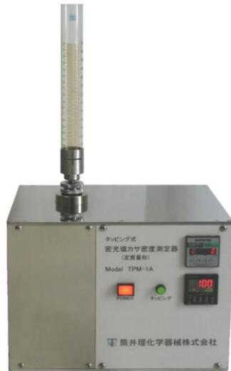
本器は上記の名称ですが其の他、粉体充填率測定器、タッピングマシン、振盪比重測定器、見掛比容積減少度測定器などの名称があり、密充填かさ密度を測定いたします。
