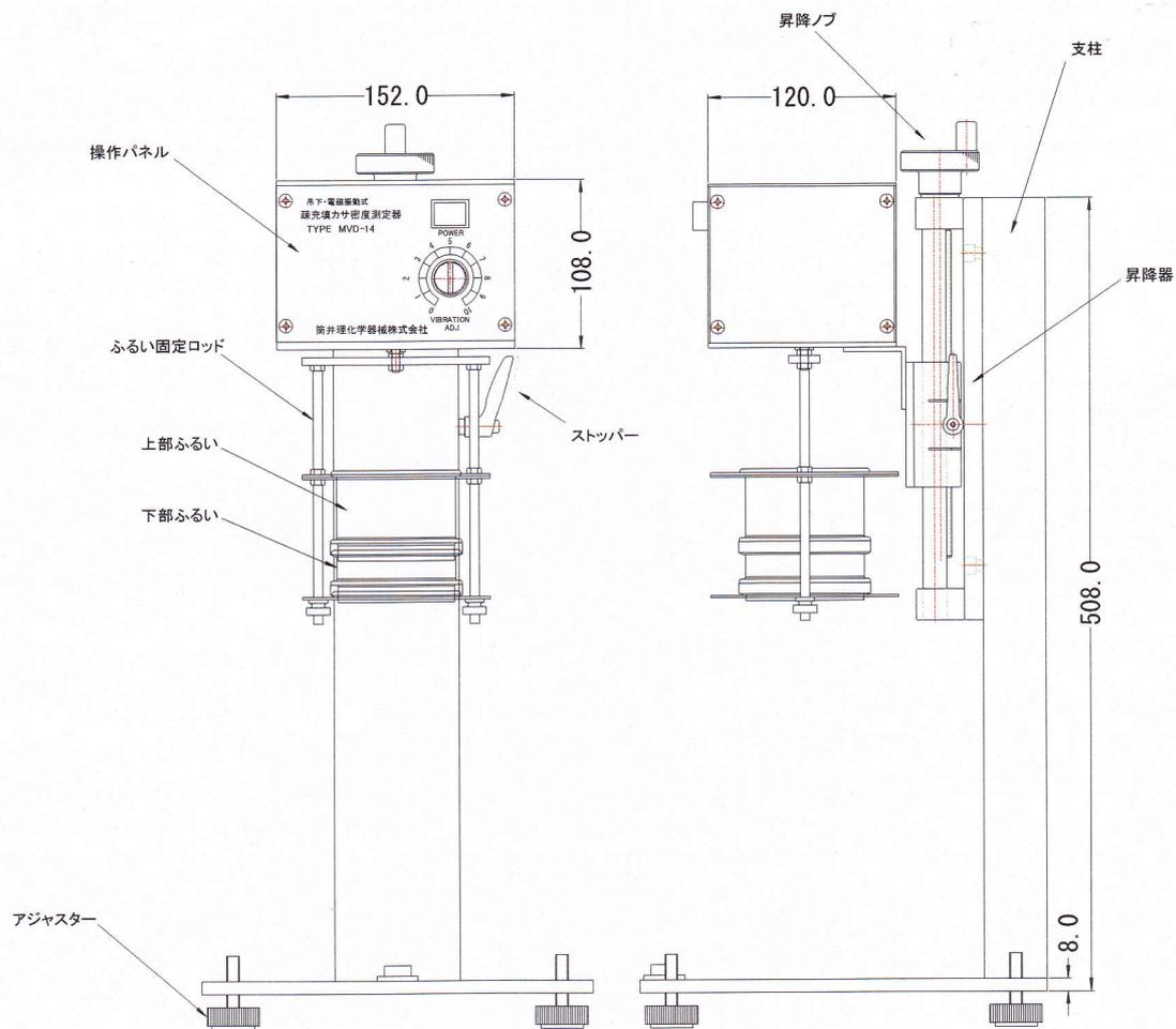
本器は、JIS 標準ふるい（直径 75mm）用に開発された吊り下げ式電磁振動ふるい器です。
