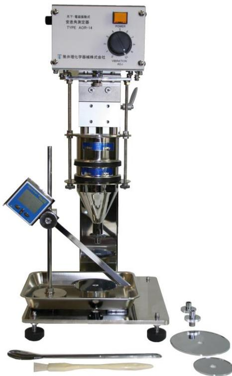
安息角の測定には各種の方法があります。列記しますと、注入法，排出法，残留円錐法，クレーター法，容器傾斜法，\*ターンテーブル法，\*\*円筒回転法，（\*，\*\*は弊社にて発売）などがあります。
